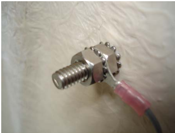
STUD / CABLE ATTACHMENT
